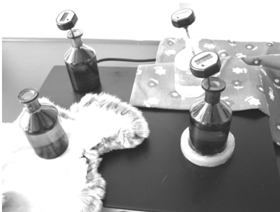
ABB 1: Versuchsaufbau: Der Isolationsschutz von 3 Materialien wird untersucht.
